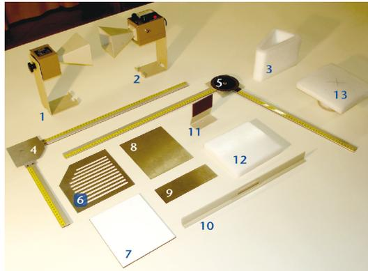
**Figura 2** Foto dos equipamentos e acessórios para micro-ondas: 1) Transmissor; 2) Receptor; 3) Molde de prisma de isopor; 4) Suporte com braços fixos; 5) Goniômetro; 6) Polarizador metálico; 7) Refletor parcial; 8) Refletor metálico, 9) Espaçador metálico; 10) Braço extensor; 11) Suporte; 12) Painel de polietileno; 13) Mesa giratória.
