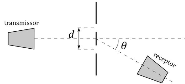
**Figura 1** Esquema do experimento de fenda dupla, indicando o espaçamento entre as fendas ( $d$ ) e o ângulo de detecção ( $\theta$ ).
